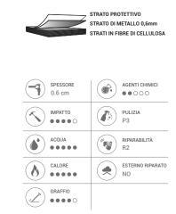
La superficie in ottone di spessore 0.6 mm ha una lavorazione manuale di spazzolatura vintage. Il supporto in HPL (high-pressure laminates) è un pannello costituito da strati di fibre di cellulosa impregnati con resine termoindurenti sottoposti ad un processo ad alta pressione (90 kg/cm2) ed alta temperatura (150 °C).
