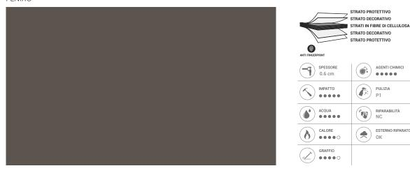
La superficie in finitura FENIX® grazie al trattamento di nanotecnologie risulta resistente al graffio, morbida al tatto e anti impronta. Il supporto in HPL (high-pressure laminates) è un pannello costituito da strati di fibre di cellulosa impregnati con resine termoindurenti sottoposti ad un processo ad alta pressione (90 kg/cm2) ed alta temperatura (150 °C).
