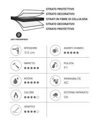
La superficie in finitura POLARIS® grazie al trattamento di nanotecnologie risulta resistente al graffio, morbida al tatto e anti impronta. Il supporto in HPL (high-pressure laminates) è un pannello costituito da strati di fibre di cellulosa impregnati con resine termoindurenti sottoposti ad un processo ad alta pressione (90 kg/cm2) ed alta temperatura (150 °C).
