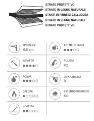
La superficie in legno naturale di spessore 0.6mm è protetta da una verniciatura all'acqua antigraffio. Il supporto in HPL (high pressure laminates) è un pannello costituito da strati di fibre di cellulosa impregnati con resine termoindurenti sottoposti ad un processo ad alta pressione (90 Kg/cm²) ed alta temperatura (150 °C)
