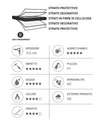
La superficie in finitura FENIX® grazie al trattamento di nanotecnologie risulta resistente al graffio, morbida al tatto e anti impronta. Il supporto in HPL (high-pressure laminates) è un pannello costituito da strati di fibre di cellulosa impregnati con resine termoindurenti sottoposti ad un processo ad alta pressione (90 kg/cm2) ed alta temperatura (150 °C).
