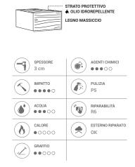
La superficie in legno viene trattata con uno strato di vernice all'acqua. Le tavole in legno massiccio sono sottoposte ad un processo di essiccazione per garantirne la stabilità nel tempo. La tecnica di giuntatura a pettine 'finger-joint' contribuisce alla costruzione di un pannello che mantiene la planarità.
