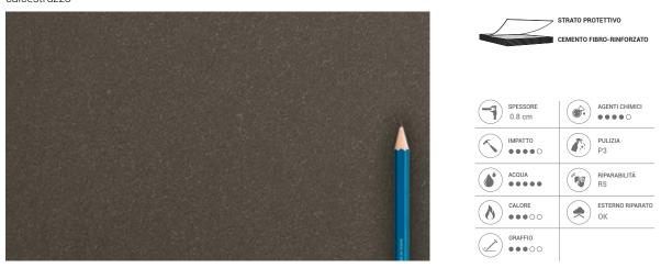
La superficie del calcestruzzo è protetta da un trattamento a cera idro-oleorepellente. Il sandwich in calcestruzzo compresso 8 mm è un pannello costituito da strati di fibre vegetali impastate con malta cementizia sottoposto ad un processo ad alta pressione.
