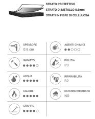
La superficie in ottone di spessore 0.6 mm ha una lavorazione manuale di spazzolatura vintage. Il supporto in HPL (high-pressure laminates) è un pannello costituito da strati di fibre di cellulosa impregnati con resine termoindurenti sottoposti ad un processo ad alta pressione (90 kg/cm2) ed alta temperatura (150 °C).
