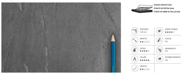
La superficie è una porzione di 2 mm di pietra naturale "a spacco" protetta da un trattamento idro-oleorepellente. Il supporto in HPL (high-pressure laminates) è un pannello costituito da strati di fibre di cellulosa impregnati con resine termoindurenti sottoposti ad un processo ad alta pressione (90 kg/cm2) ed alta temperatura (150 °C).
