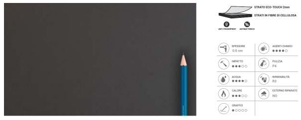
La superficie in eco-touch di spessore 2 mm è un impasto di origine organica 100% naturale (sughero, juta, olio di lino). Il supporto in HPL (high-pressure laminates) è un pannello costituito da strati di fibre di cellulosa impregnati con resine termoindurenti sottoposti ad un processo ad alta pressione (90 kg/cm2) ed alta temperatura (150 °C).
