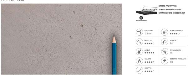
La superficie in cemento di spessore 2 mm è colata in cassero e applicata all'HPL, protetta da un trattamento idro-oleorepellente. Il supporto in HPL (high-pressure laminates) è un pannello costituito da strati di fibre di cellulosa impregnati con resine termoindurenti sottoposti ad un processo ad alta pressione (90 kg/cm2) ed alta temperatura (150 °C).
